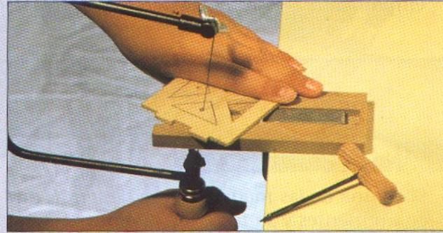
Para efectuar un *corte interior*, conviene hacer primero un agujero en el material e introducir el pelo por él. Después, se sujeta al arco de la sierra y se procede a cortar.
