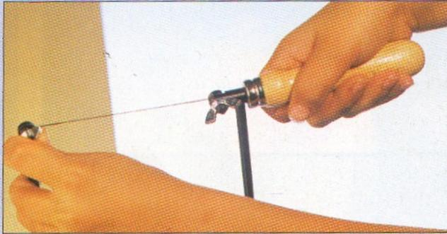
Antes de empezar a cortar, hay que sujetar bien el pelo con las dos palomillas. Los dientes deben colocarse siempre *mirando hacia la empuñadura*.
