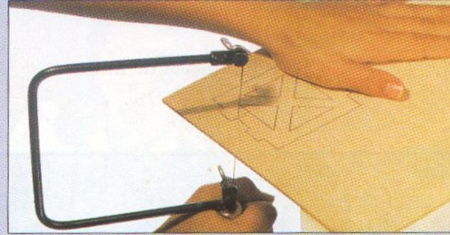
El pelo debe permanecer *perpendicular a la superficie* que se desea cortar. Hay que ejercer presión en el movimiento de *arriba abajo*.
